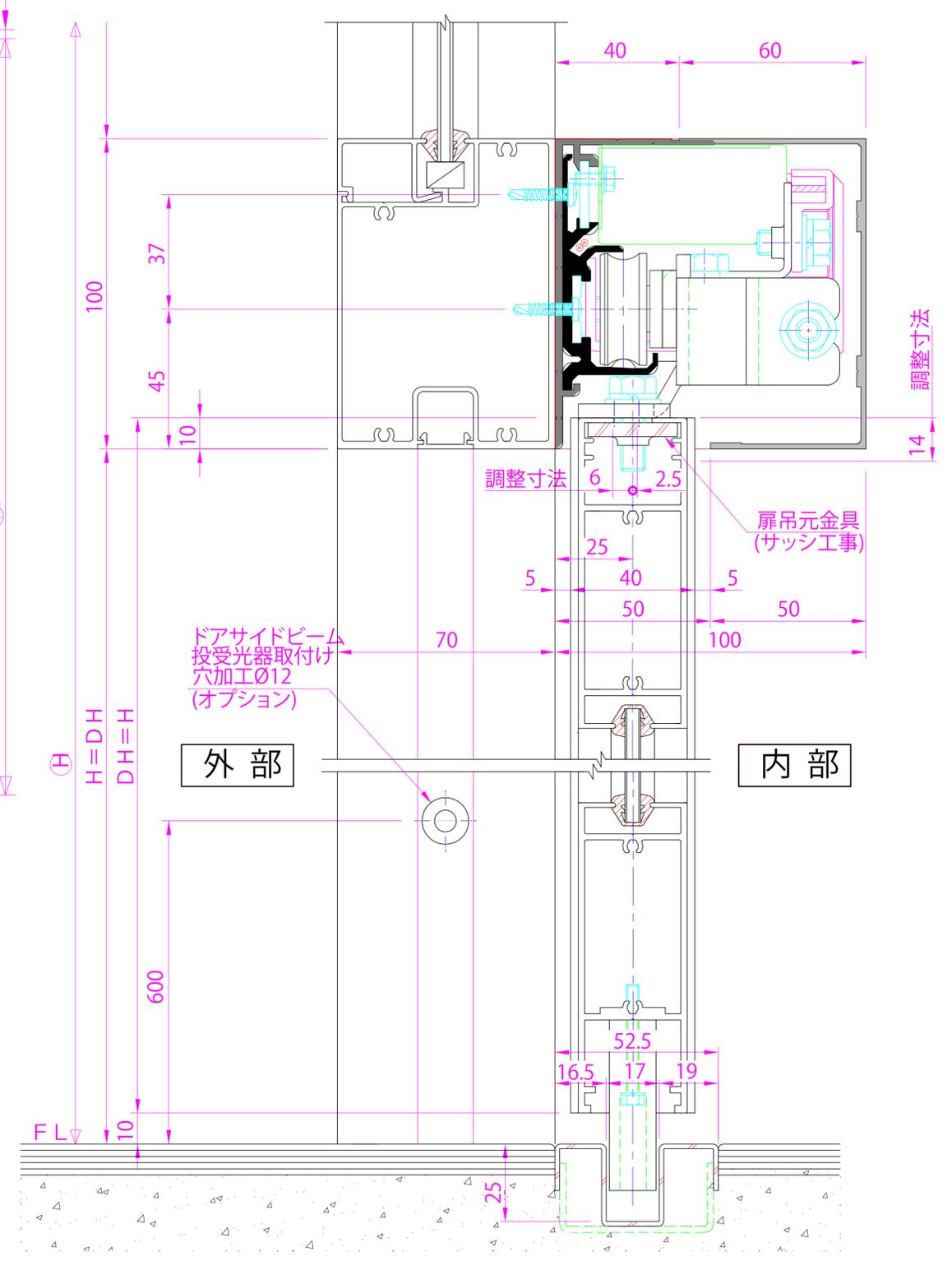
● 後付式(簡易)ダイムオートドア『BEタイプ』は、見付100mm ×見込100mmのコンパクト形状を実現し、100mm見付サッシにもピッタリと納り意匠的にも優れています。DW914×2134の強化ガラスの片引・引分に対応できます。
