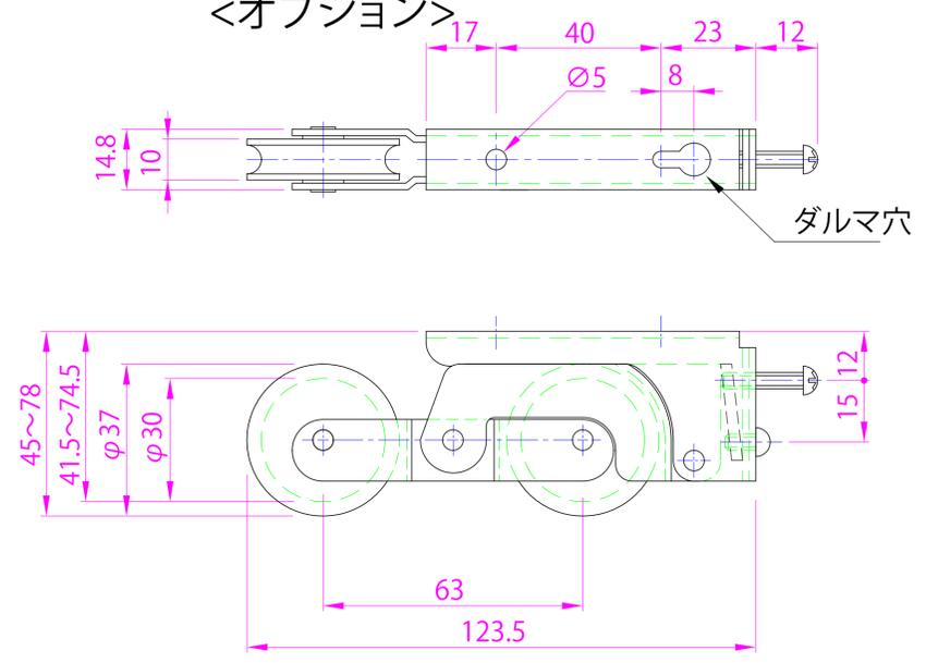
● 下車式(簡易)ダイムオートドア『BDタイプ』は、現在手動開閉のアルミ框ドアや木製ドア等の引戸をそのまま自動化します。
