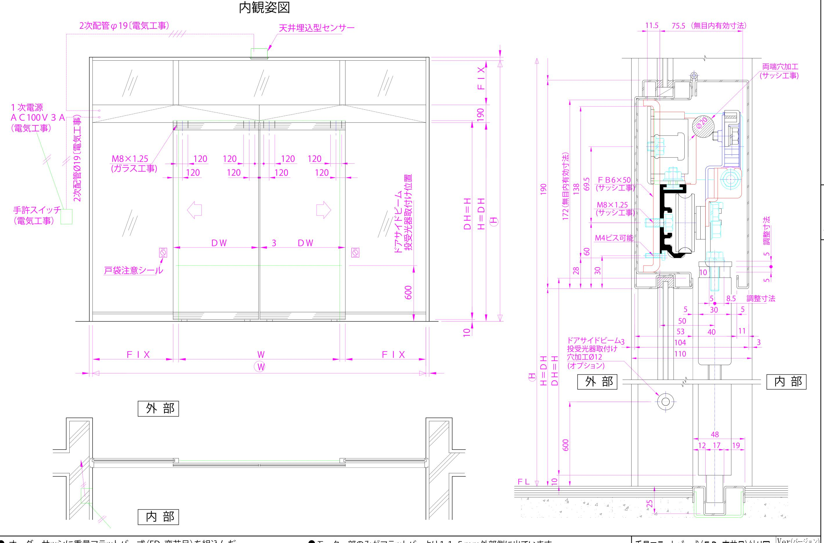
● オーダーサッシに重量フラットバー式(FD・変芯吊)を組込んだ 最小断面図ですが、余裕をもった寸法でご設計をお願いします。
