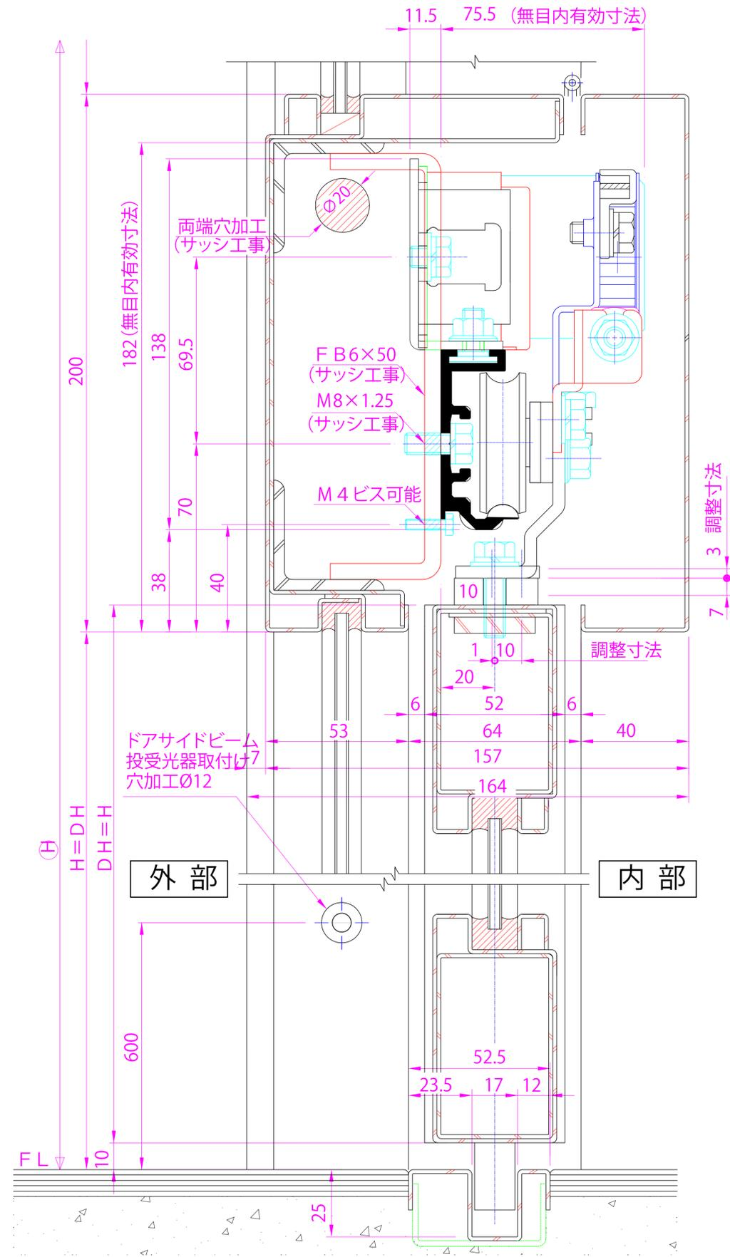
● オーダーサッシに重量フラットバー式(FD・中芯吊)を組込んだ最小断面図ですが、余裕をもった寸法でご設計をお願いします。
