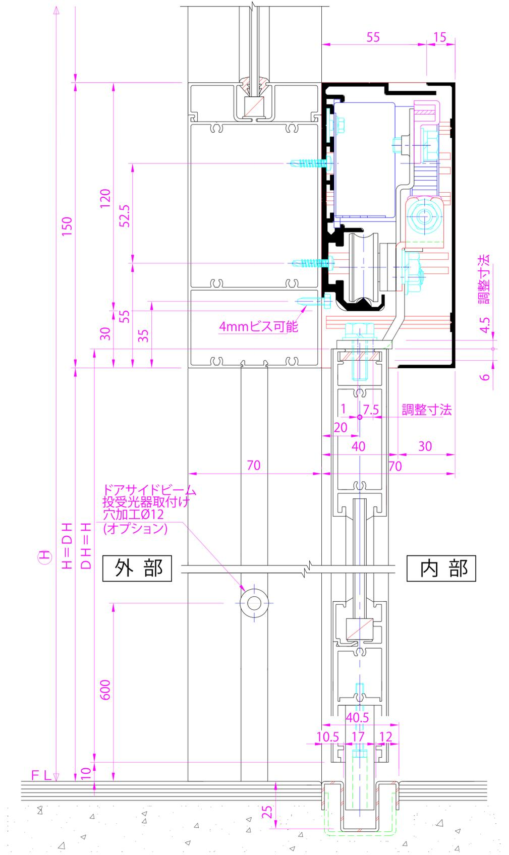
● 後付式ダイムオートドア『NCタイプ』は、超小型モーターの搭載と独自の技術を駆使し、コンパクトでスマートな70mm見込が可能となりました。
