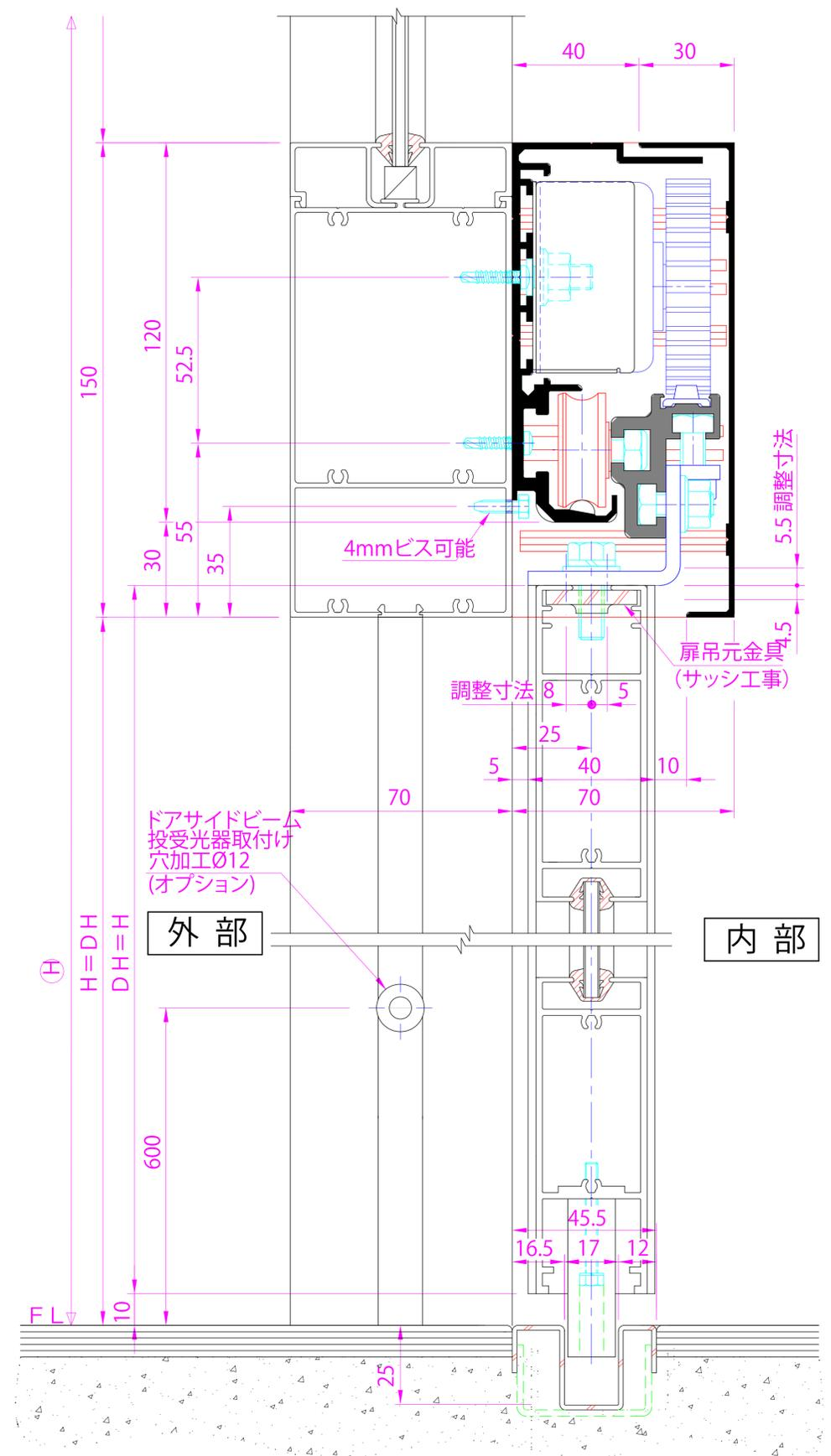
● 後付式ダイムオートドア『NCラック・ピニオンタイプ』は、既設・新設の鴨居やフロント無目に取付けする自動ドア装置として開発された画期的な製品です。省部品化をはかるために従来の自動ドアに使用されているタイミングベルトや従動プーリー・連結金具関係の部品をなくし、ドア吊込み金具である背板部のランニングバーに組込まれた、ラックとモーターユニット側のピニオンによって開閉させる方法が最大の特長です。
