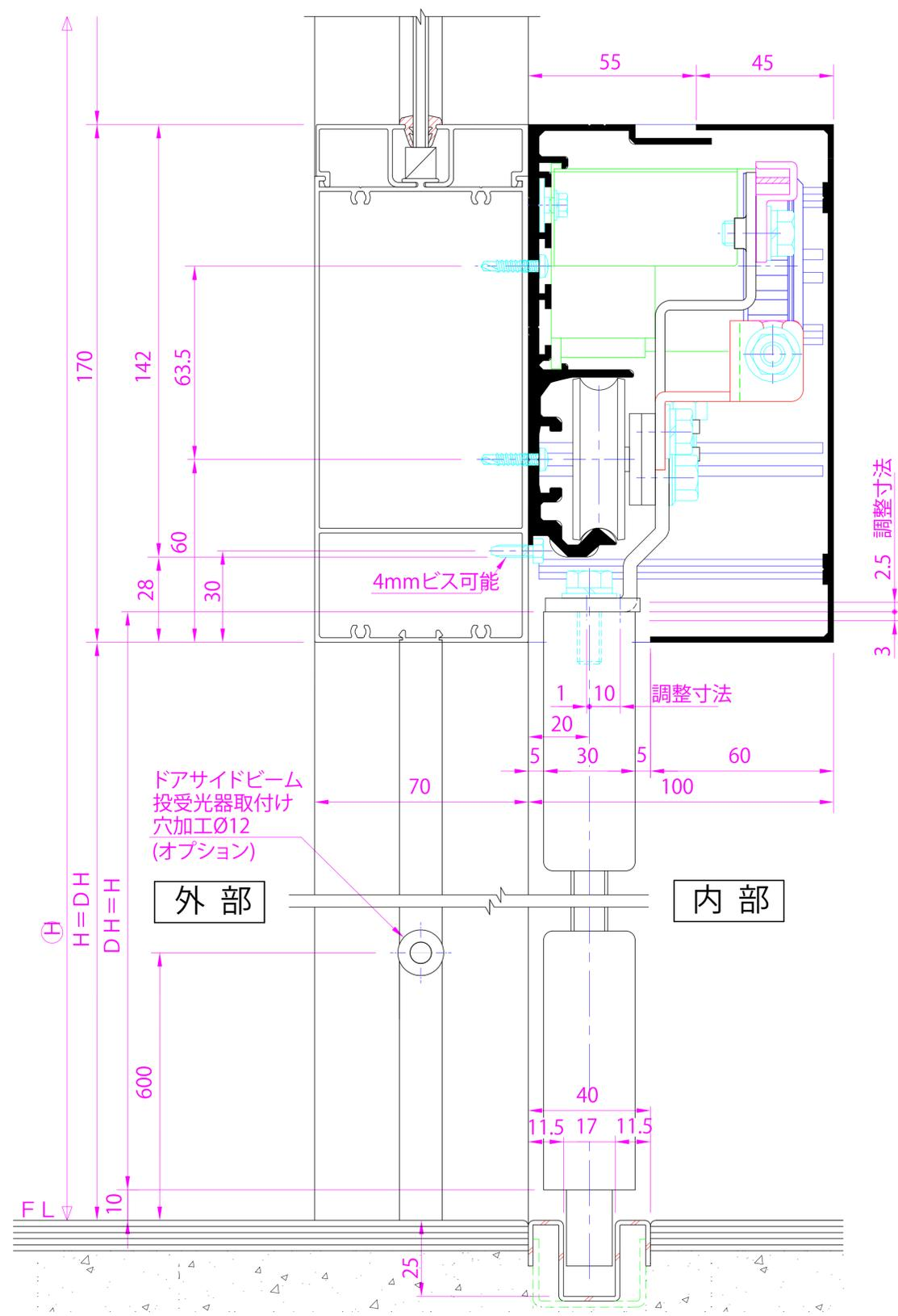
●重量後付式ダイムオートドア『BGタイプ』は、既設・新設の鴨居や無目に取り付けする自動ドアです。φ45ダブルローラーを使用していますので、扉重量が重く使用頻度の多い出入口向きの自動ドア開閉装置です。ベース上に機構取付溝を設けて、各部品を組み込みするフリースライド方式を採用し、取付け先で切縮めがあっても簡単に部品の移動・固定ができます。
