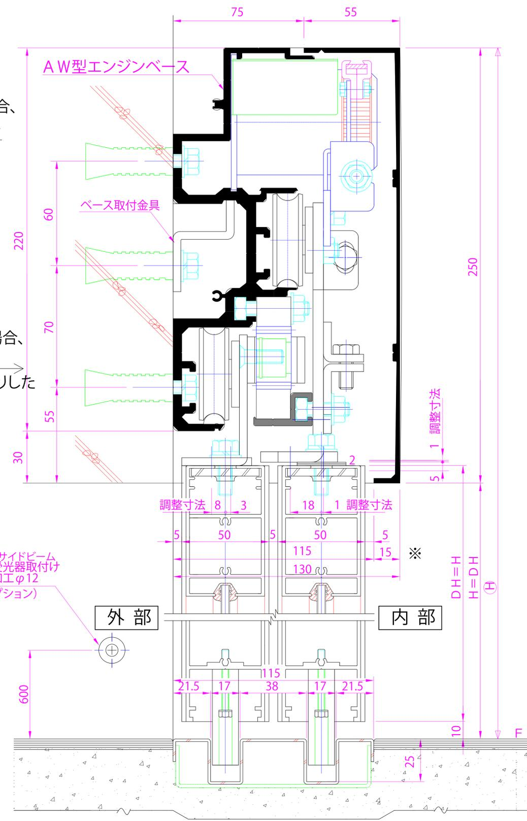
● ダイムオートドア『AWタイプ』は、高速・低速の2枚のドアが運動し、同じ方向に同時に動作、全開時には戸袋側に完全に重なるメカニズムです。限られた間口で開口スペースを広く確保したい店舗や工場、倉庫、手術室等、荷物や医療機器の通路に最適な自動ドアです。φ45ダブルローラーを使用していますので、扉重量が重く使用頻度の多い出入口向きの自動ドアです。エンジン全長、ドア幅の計算式はC-5をご参照下さい。見込100mm×見付200mmの小型2重引戸・CNタイプはC-3をご参照下さい。
